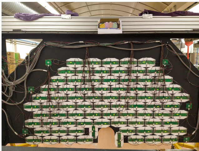
Рис. 9: Фотография годоскопа ANTI-0 в чистой комнате (ЦЕРН).
