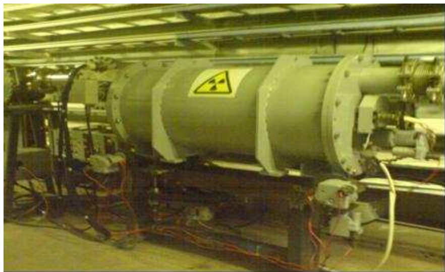
Рис.2.5 Устройство для коллимации пучка
