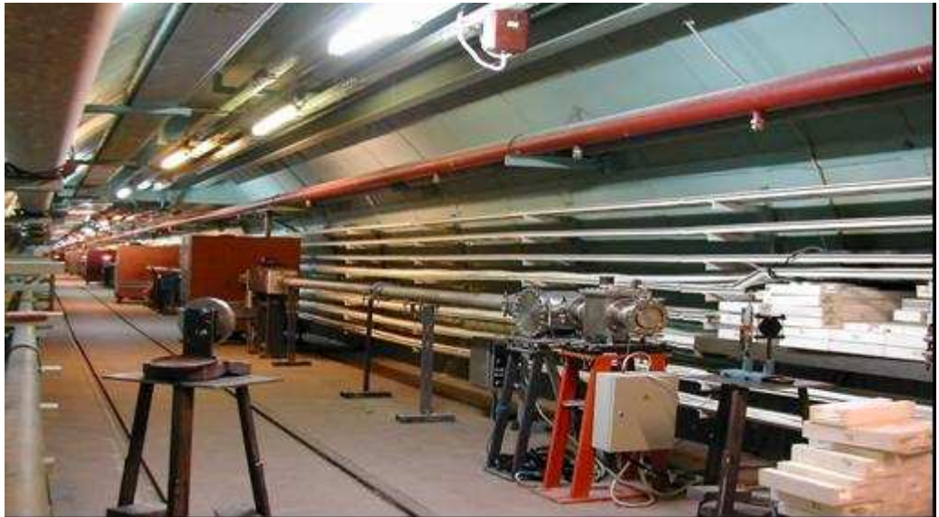
Рис 2.4 Протонная радиографическая установка в канале инжекции
