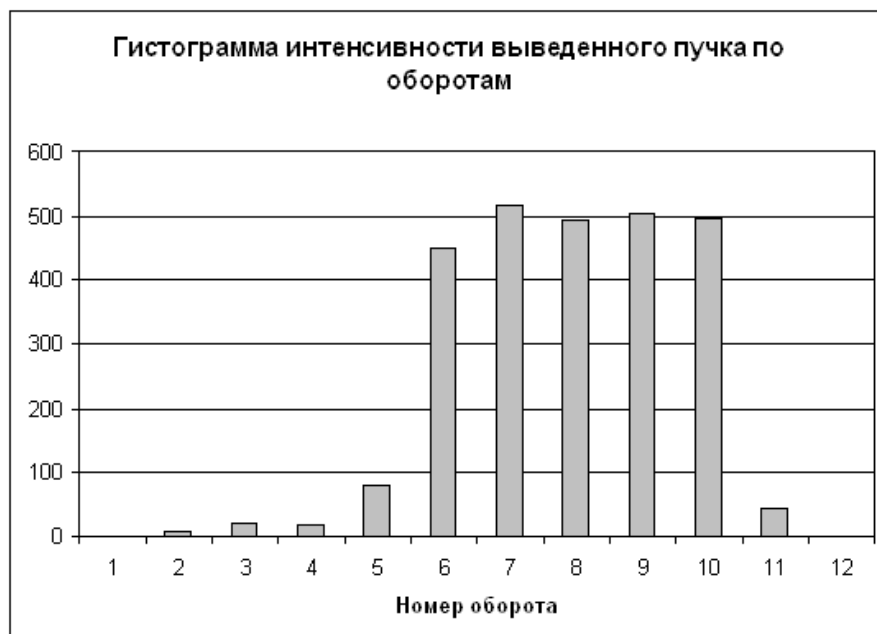
Рис. 4.13 Гистограмма интенсивности выведенного пучка по оборотам (длительность вывода 5 оборотов)
