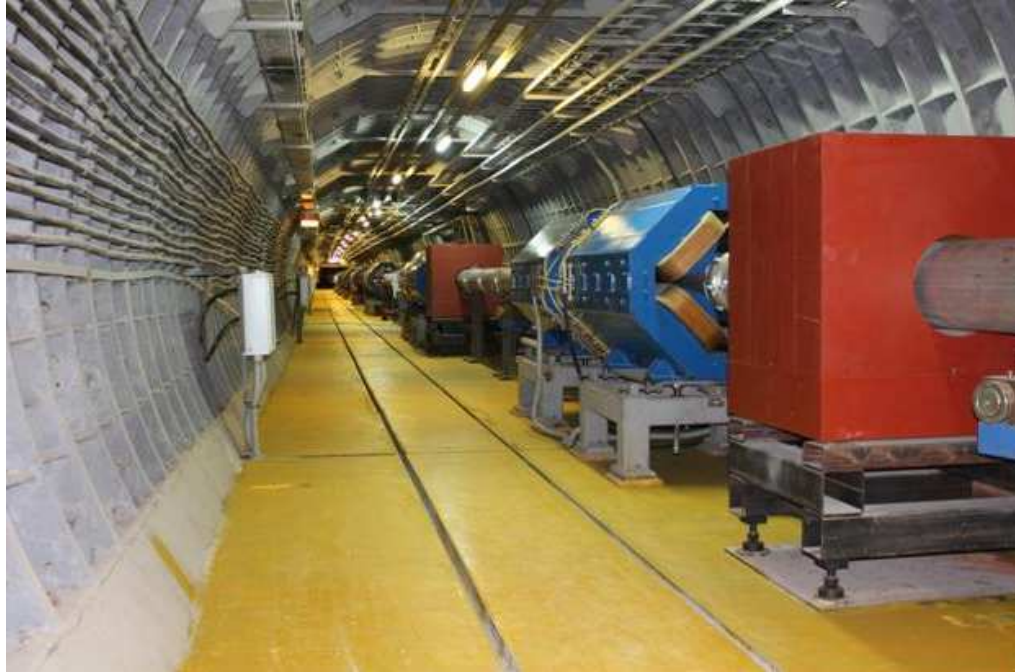
Рис.1 Участок установки ПРГК-100 с квадрупольными линзами и блоками радиационной защиты
