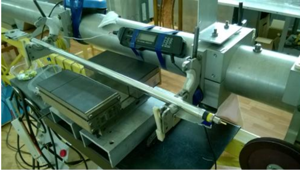
Рисунок 25 - Фотография сборочного станда с собранной ДТМ
