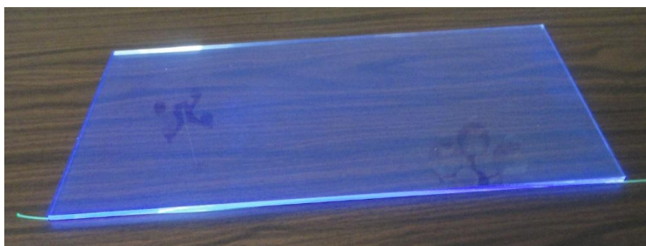
Рисунок 30 - Образец сцинтиллятора прямоугольной формы для использования в «горячих зонах» установки АТЛАС.
