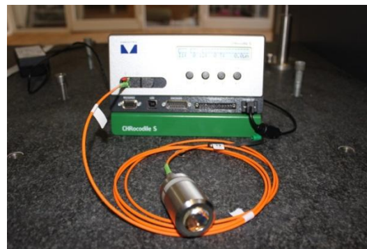
Рисунок 10 - Принцип действия (а) и фотография (б) системы бесконтактного топологического измерения поверхности печатной платы
