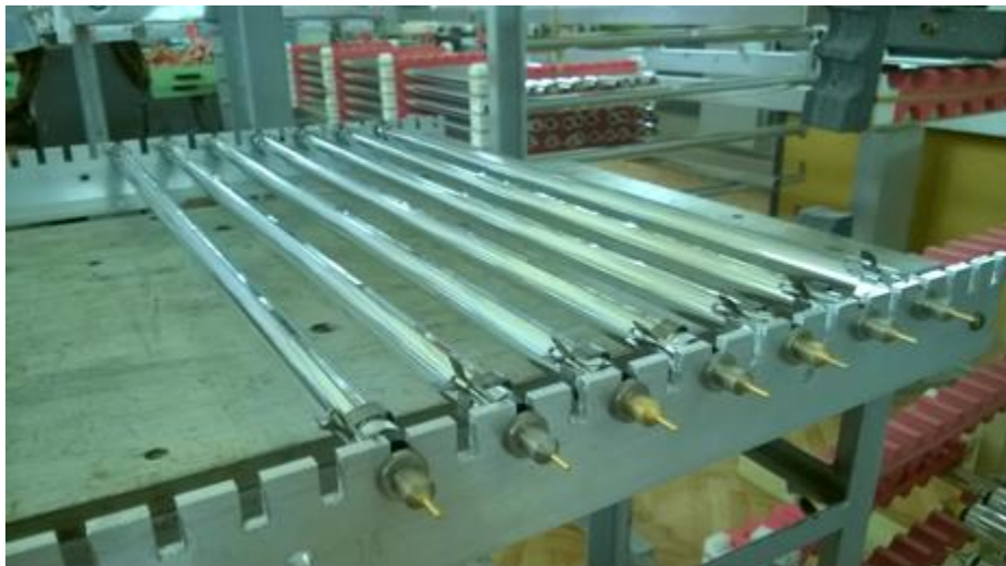
Рисунок 26 - Стенд выдержки ДТМ на время отверждения клея
