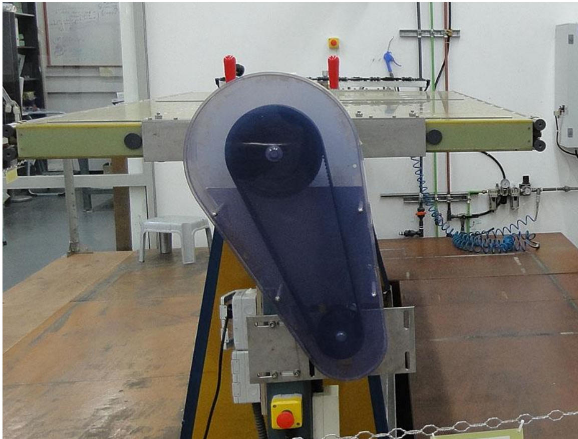
Рисунок 1 – Фотография устройства для натяжения проволок ТЗК.
