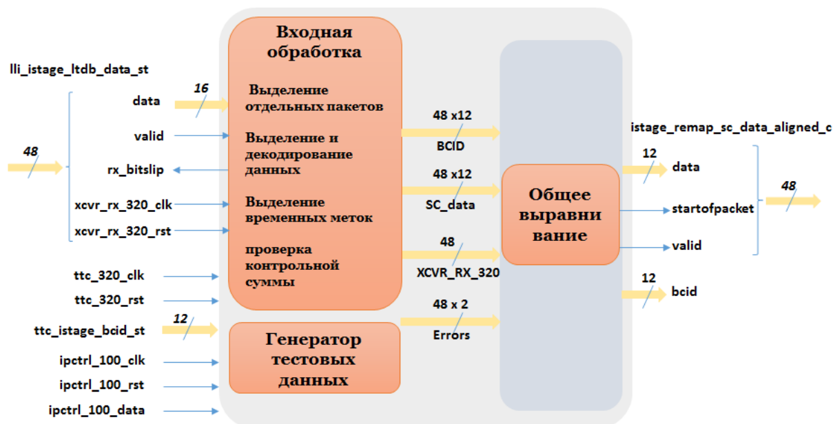
Рисунок 33 - Функциональные элементы блока декодера
