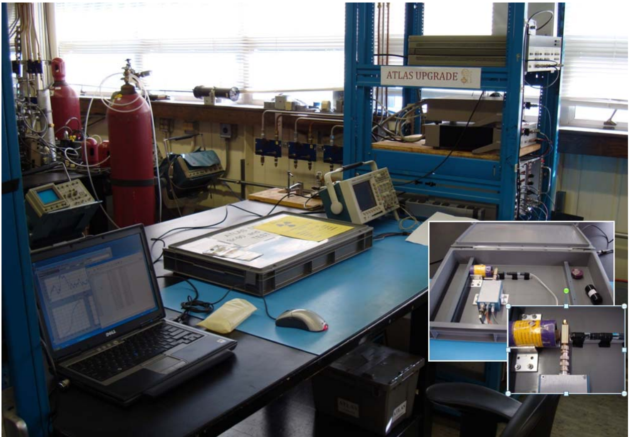
Рисунок 42 - Лабораторный тестовый стенд - прототип измерительного стенда на ИБР-2м.
