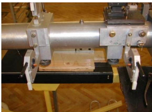
Рисунок 39 - Полеформирующие проволоки растянуты на стапеле (слева) и их крепление в диэлектрической шайбе (справа).
