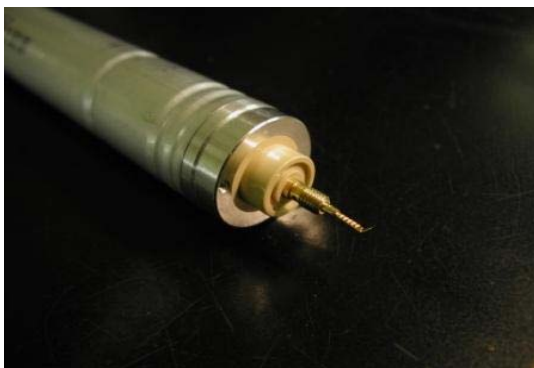
Рисунок 41 - Внешний вид торца трубки с полеформирующими проволоками, справа – образец трубки с вырезанными окнами для демонстрации крепления и электрических соединений проволок.
