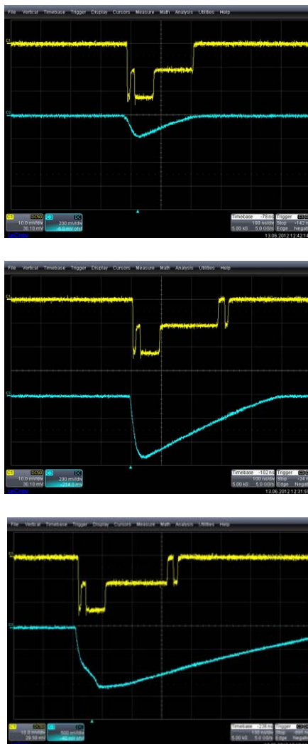
Рисунок 35. Осциллограммы сигналов с выхода микросхемы ASDBLR для сигналов различной амплитуды в стримерном режиме от источника ^{241}\text{Am} . Верхняя и центральная осциллограммы соответствуют первой стримерной моде, нижняя – второй.
