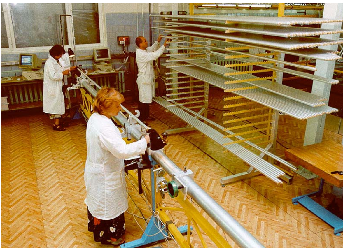
Рисунок 38 - Участок сборки дрейфовых трубок
