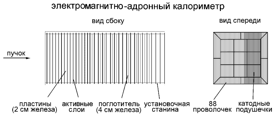
Рис. 7.31: Типичная схема электромагнитно-адронного калориметра со стримерной трубкой в качестве активного слоя [540].
