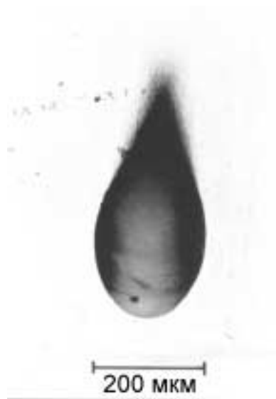
Рис. 4.97: Конус травления, порожденный ядром железа в пластиковом детекторе [372]. Ширина трека составляет 193 мкм.
