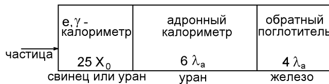
Рис. 7.47: Гибридный электромагнитно-адронный калориметр.
