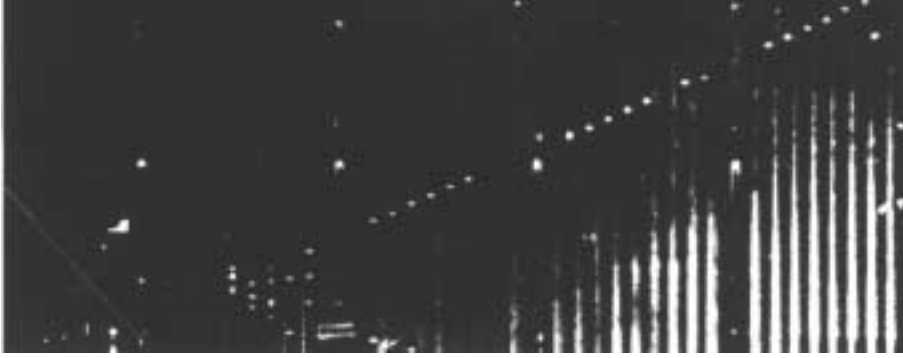
Рис. 11.11: Рождение мюона при нейтрино-нуклонном взаимодействии [653,654].
