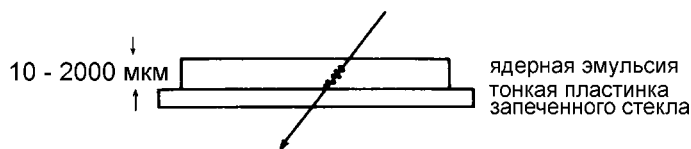
Рис. 4.88: Принцип измерений в ядерной эмульсии.
