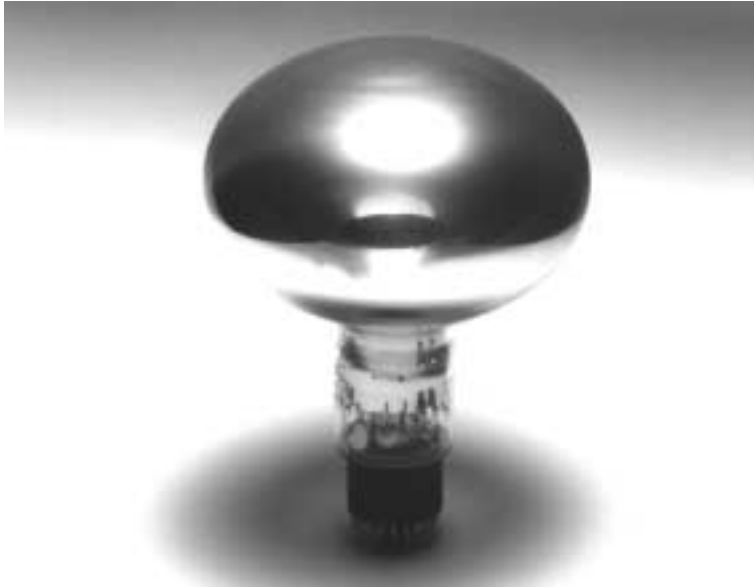
Рис. 5.3: Фотография 8-ми дюймового ( \approx 20 см) фотоумножителя (тип R 4558) [382].
