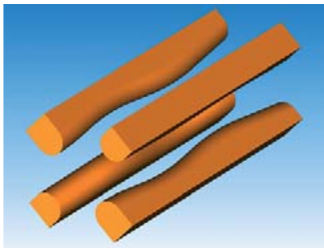
Рис. 2.1а. Electrodes ускоряющей структуры с пространственно однородной квадрупольной фокусировкой (ПОКФ).
