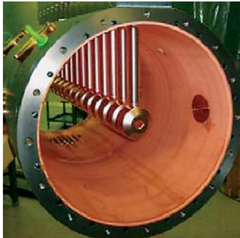
Рис. 2.4. Основная часть ускорителя ОЧУ-2 (Альварец).
