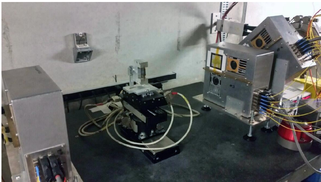
Рисунок 1.9 – Изображение кристалла, установленного на гониометре высокого разрешения, и 3-х ближайших трековых станций. Квадрат в левом верхнем углу трековой станции соответствует активной области XY-плоскостей мультистрипов. Также на этой трековой станции видны два вентилятора и оптические волокна, посылающие сигнал на систему сбора данных
